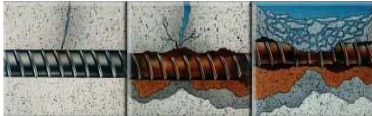
Nedbrytningsförlopp i betong med Armeringskorrosion, Rost- & Frostsprängningar
