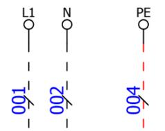
Die Auslegung der Leiterquerschnitte für die Einspeisung muss nach VDE0113-1 / EN60204-1 erfolgen. / Cross section dimensioning for line power supply must be done according to VDE0113-1 / EN60204-1.
