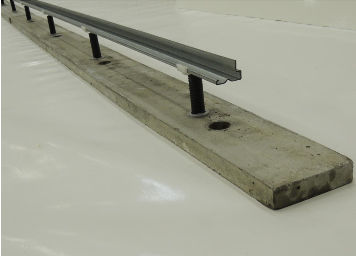
Figur 5 Plåtbanan alt betongbanan fästes i hållaren.
