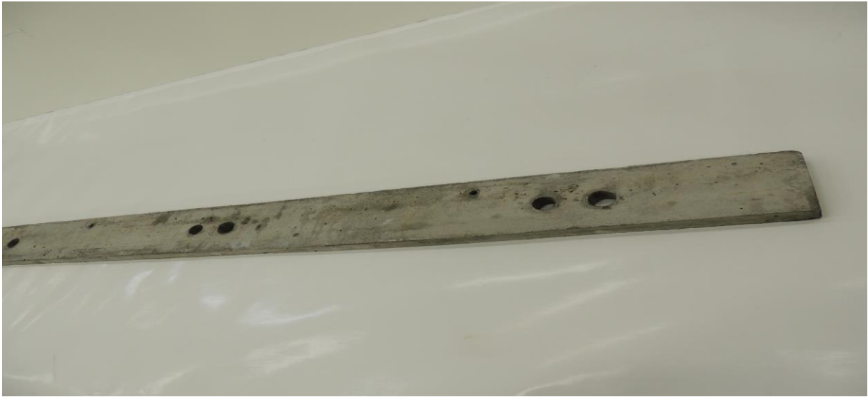
Figur 1 Uraconplank. Vikt 25 kg. Längd 2400 mm. Bredd 150 mm och höjd 30 mm. Läggs på befintligt underlag.
