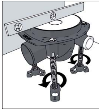
Kuva 93. Vieser One -lattiakaivon tukeminen betonivalun yhteydessä.
