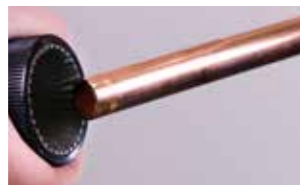
2. Slipa bort och ta bort alla yttre vassa kanter
